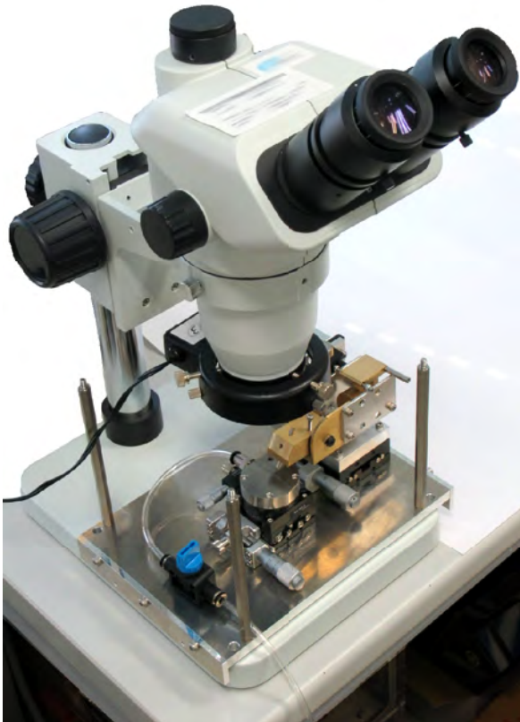
実体顕微鏡(マイクロネット株式会社製 nobita)に載せたスクライバー。横のネジで固定する。
